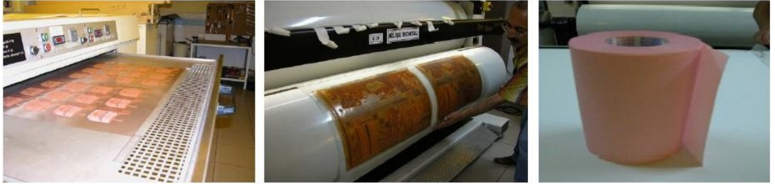
Fotoğraf 3.4 Flekso Baskı Makinesi Baskı merdanesi ve kalıplar Esnek kalıp
