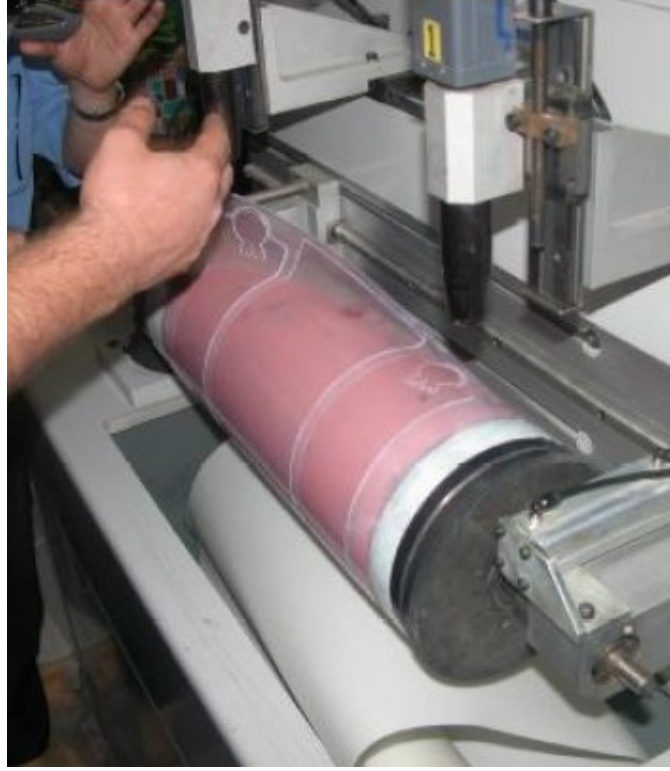
Fotoğraf 3.6 Flekso kalıp hazırlığı diğer tekniklerle göre pahalı ve karmaşık bir işlemdir.
