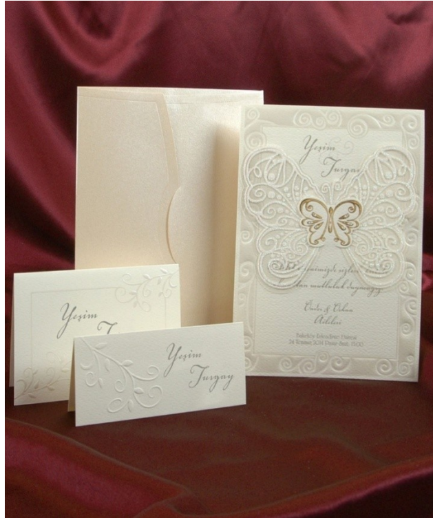
Fotoğraf 3.3 Gofre-çukur baskı, özel kesim işlemleri hala, büyük ölçüde Tipo Baskı makineleri ile yapılmaktadır.
