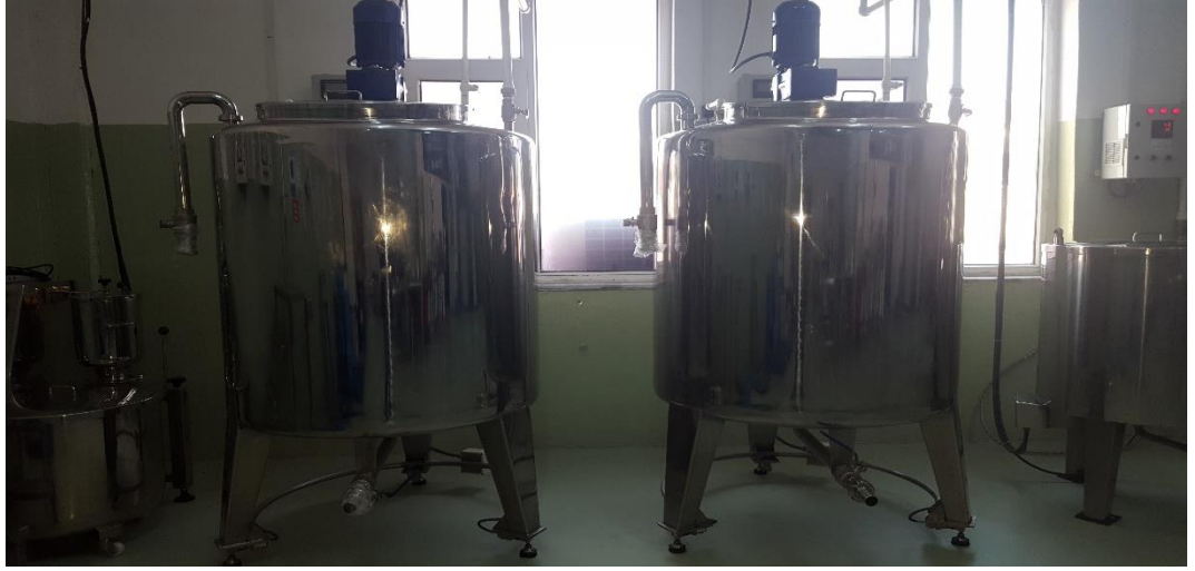
Şekil: 5.5. 1'er tonluk şampuan üretim mikserleri
