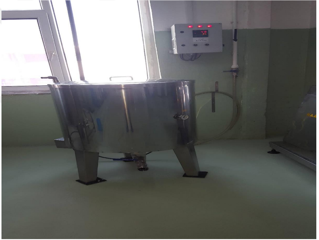
Şekil: 5.5. 1'er tonluk şampuan üretim mikserleri
