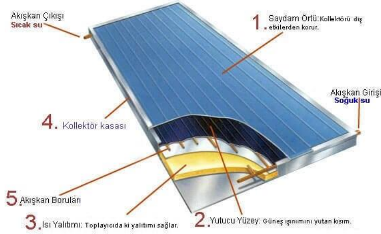
Kaynak: http://www.thesisat.org/duz-yuzeyli-gunes-enerjisi-kollektorleri.html Şekil 2.15 Kollektörü Oluşturan Elemanlar
